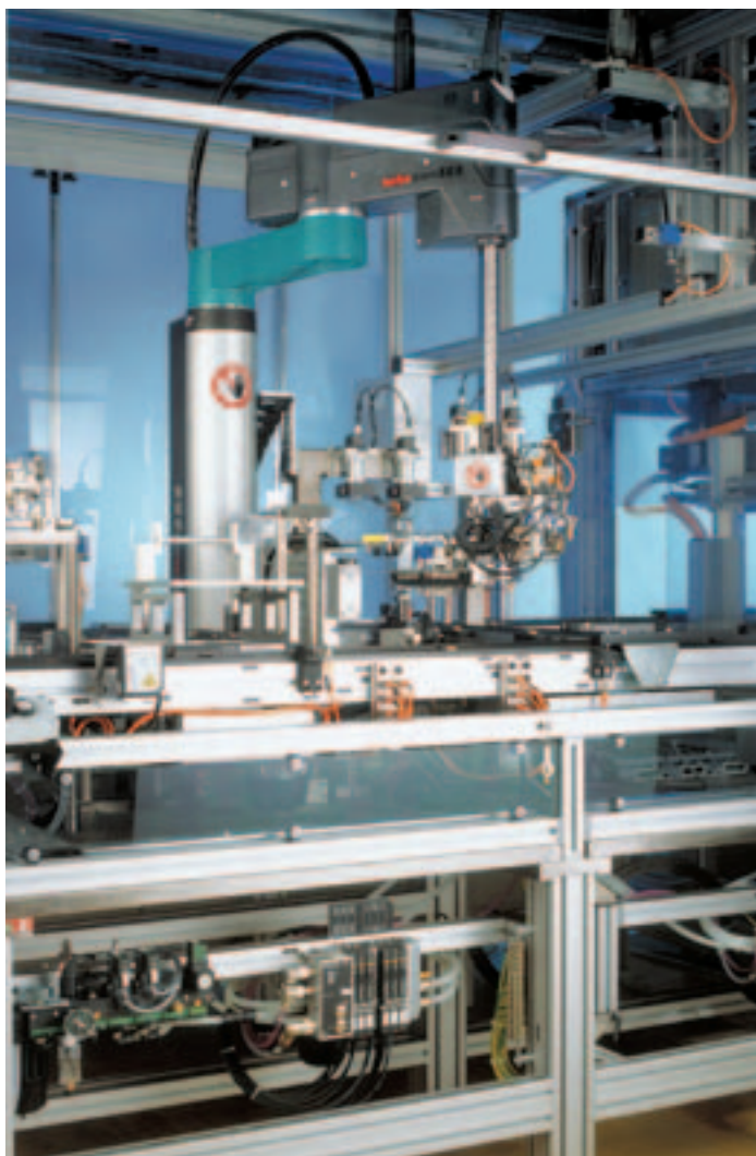
▲ Cabina di lavoro del robot flessibile con sistema di trasferimento Célula de robò flexible con sistema transfer Célula de robò flexível para sistema tranfer Robert Bosch GmbH, Stuttgart, D
