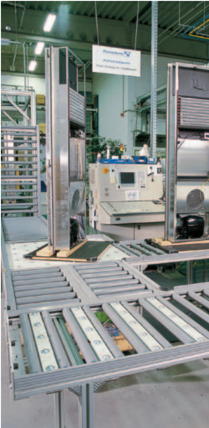
Sistema di montaggio manuale per la produzione di frigoriferi di fino a 75 kg di peso e a 2 m di altezza Sistema de montaje manual para la producción de equipos de refrigeración de hasta 75 kg de peso y 2 m de altura Sistema de montagem manual para a produção de refrigeradores com um peso de até 75 kg e altura de 2 m Pfannenberg GmbH, Hamburg, D Made by Handke Industrietechnik, Hamburg, D
