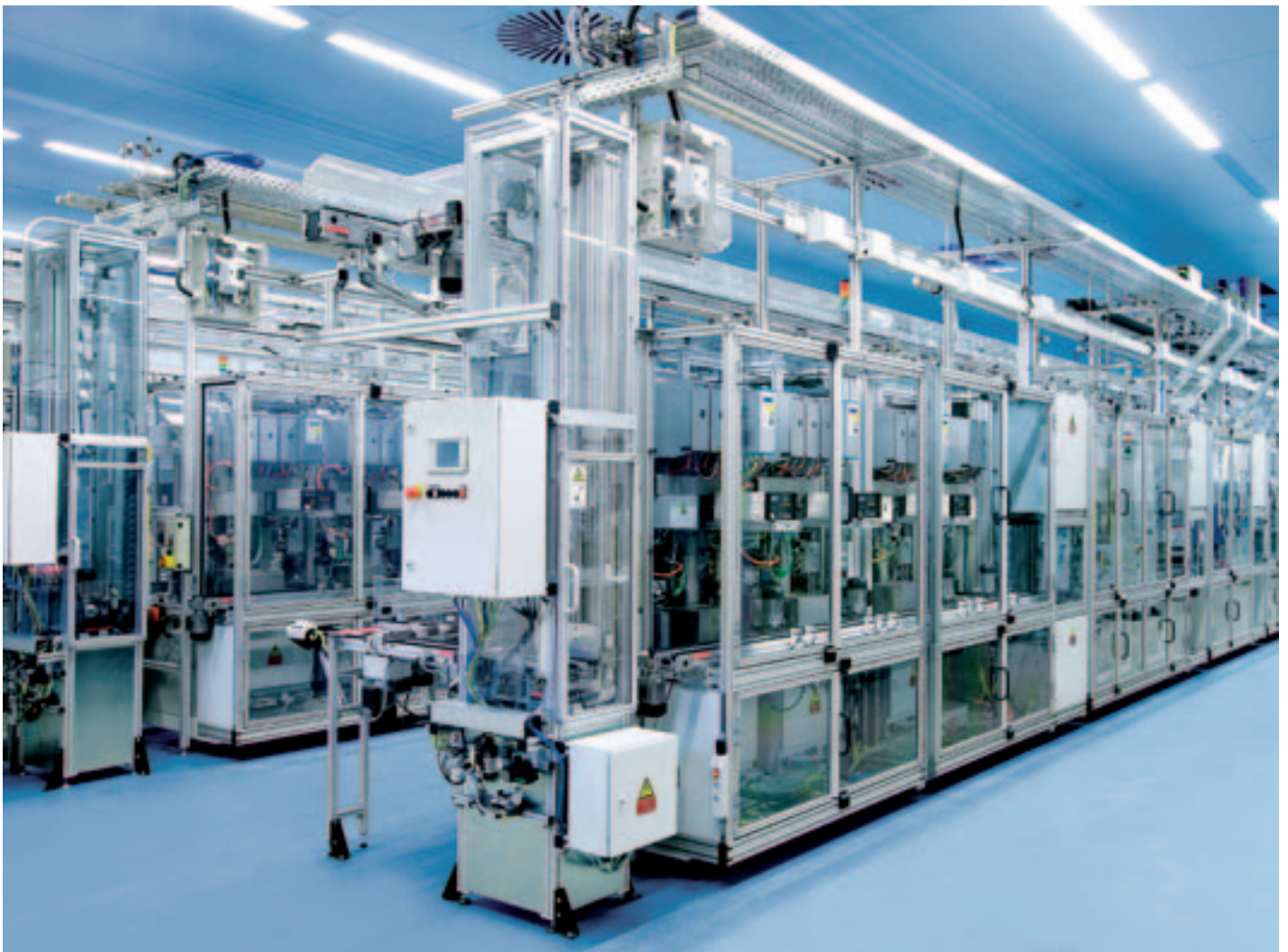
Linea completamente automatica, produzione di attuatori Línea totalmente automática, producción de actores Linha completamente automática, produção de atuador Robert Bosch GmbH, Bamberg, D
